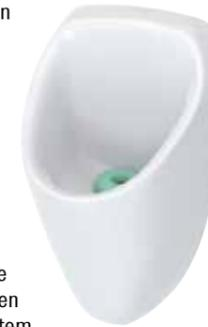
Das Keramikbecken wird mit verdeckten Schrauben vandalsicher an die Wand gehängt. Ein patentierter, auf das Ventil aufgesetzter Ring sorgt für angenehmen Duft und reinigt mit einer biologisch aktiven Füllmasse Ventil und Abflussleitungen. Eine farbige Biomasse ist zuverlässiger Wechselindikator. Ist sie verbraucht, muss das Ventil und der Ring
